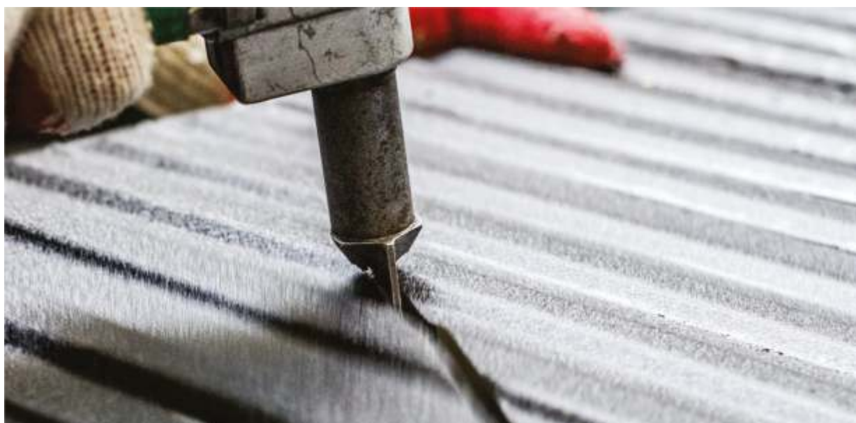
W odróżnieniu od paneli z posypką, panele RITA można ciąć niblerem, bez ryzyka jego uszkodzenia.
