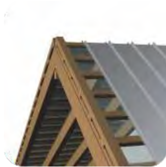
Rys.26 Montaż deski szczytowej
