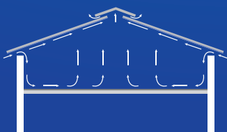
Odpowiednia wentylacja w izolowanym budynku z dopływem powietrza po bokach i odpływem powietrza przez kalenicę dachu.
