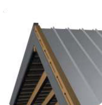
Rys. 28 Montujemy obróbki szczytowe.
