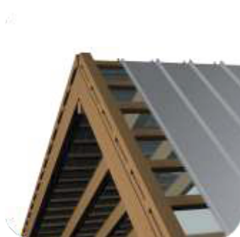
Rys. 25 Montaż deski szczytowej
