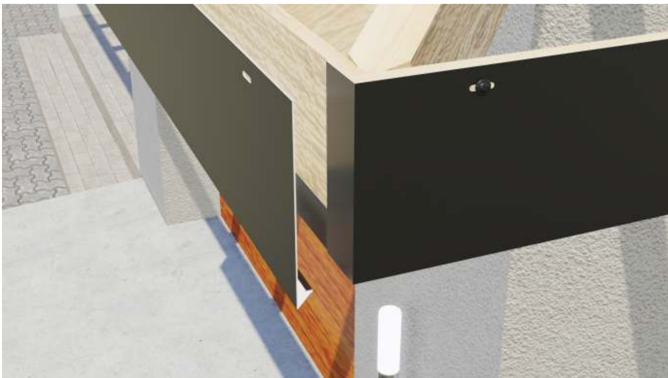
Przykład łączenia pasów podrynnowych na rogu.
