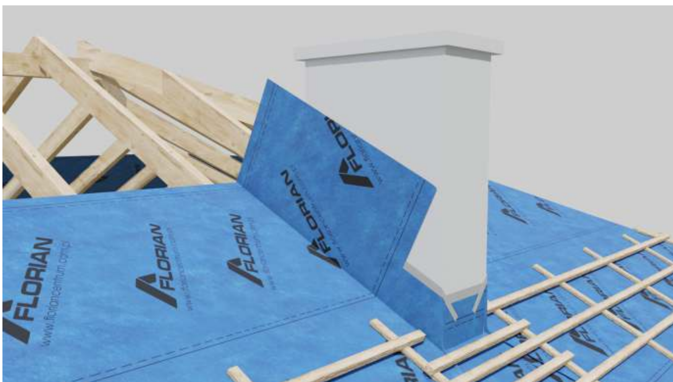
Zakład tylnej membrany powinien być na tyle duży, żeby umożliwić przymocowanie jej do kolejnej krokwi za kominem.
