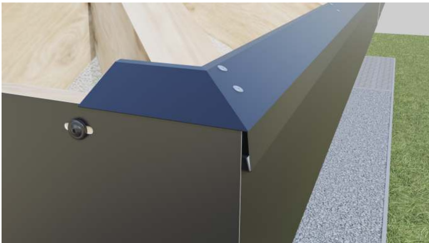
Łączenie obróbek okapu na zakładkę w narożniku.
